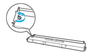
7. 依圖示將色帶匣裝入印表機,然後壓住兩側的塑膠卡榫使其插入印表機的插槽中。
